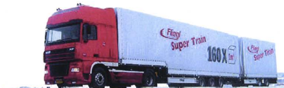
Рис.1. Седельно-прицепной автопоезд длиной 25,25м, объемом кузова 160м 3 .
