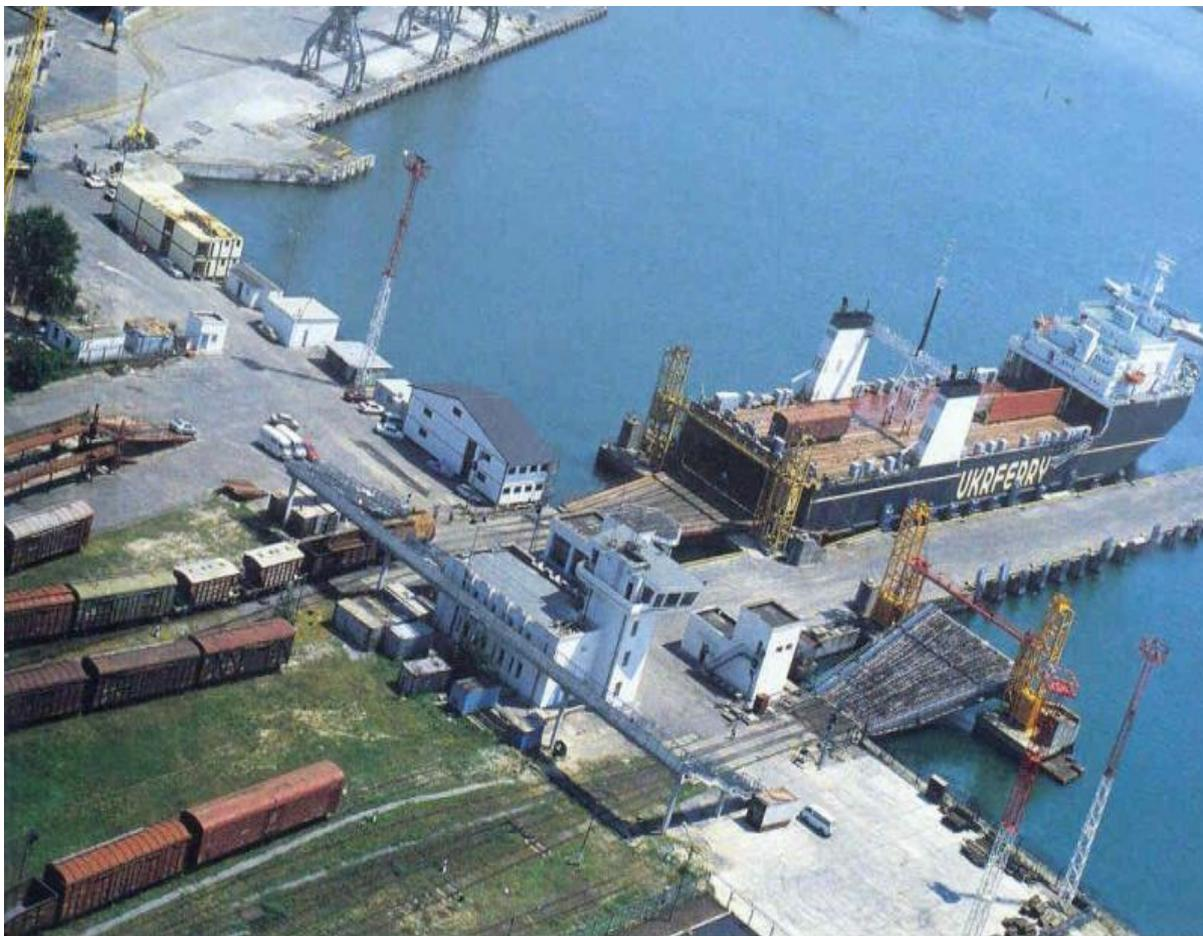
На Каспийском море функционируют четыре специализированных паромов для перевозки сжиженного газа из Актау до Махачкалы. Такие суда могут транспортировать до 56 цистерн или вагонов. Сжиженный газ также транспортируется по маршруту Туркменбаши-Баку и Туркменбаши-Махачкала паромов типа "Советский Дагестан" с вместимостью в 28 цистерн. Также использовались паромы с вместимостью в 56 цистерн.
