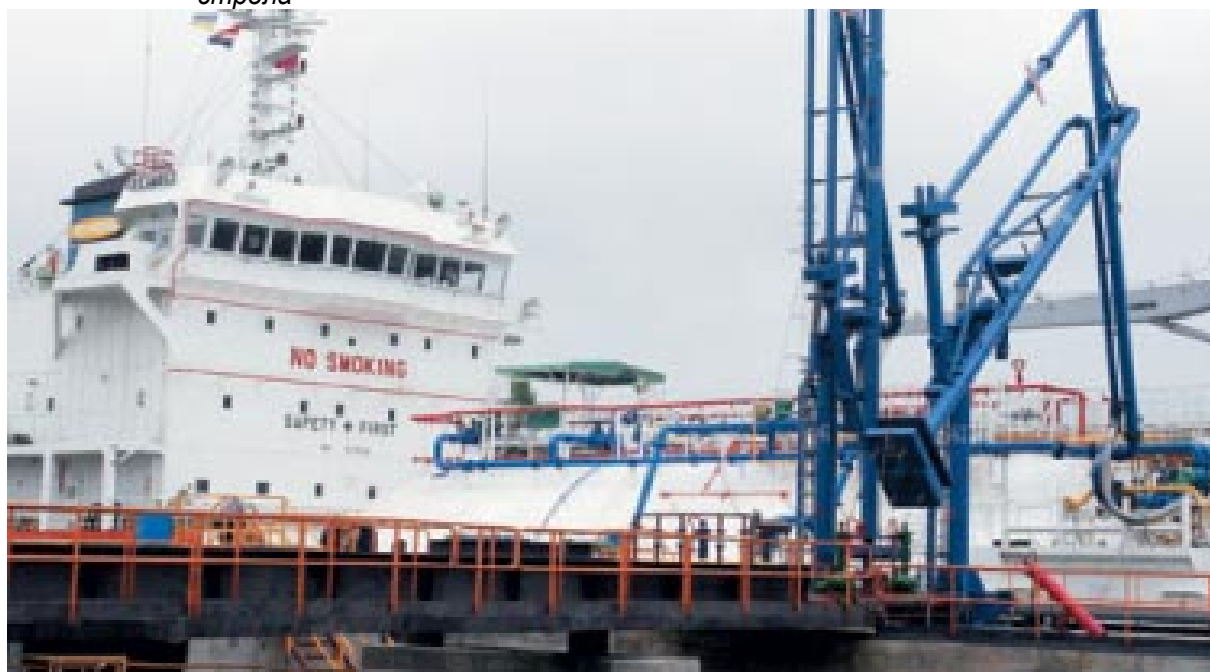
Рисунок 2.3 Погрузка на судно для сжиженного нефтяного газа – специальная погрузочная стрела
