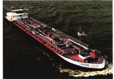
Судно для перевозки жидких навалочных грузов
