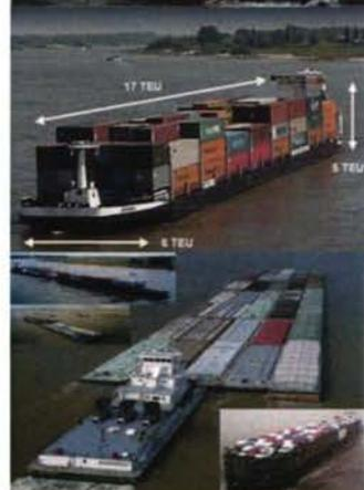
Конвой, буксируемый методом толкания
