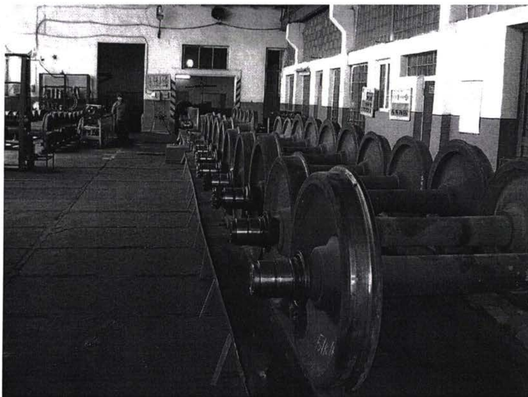
Фотография 2 - Депо в Душанбе – Место Обточки колесных пар
