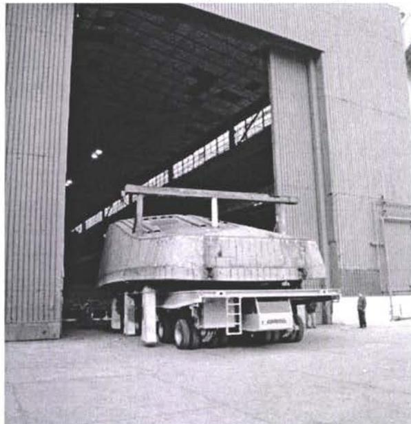
Кормовая часть на дороге на содоподъемный элинг для поворота корпуса
