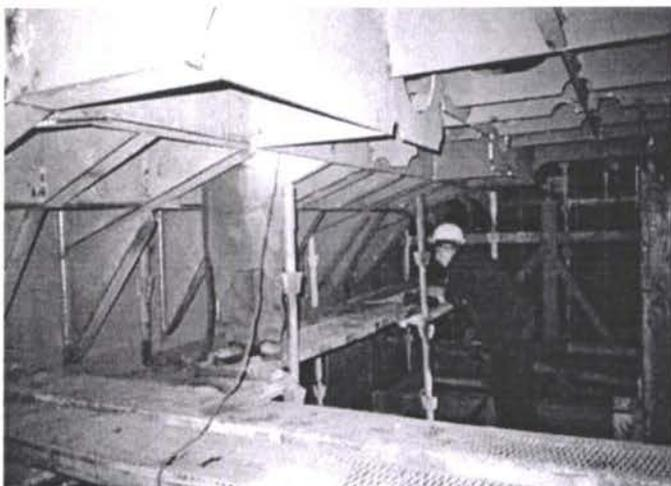
Рамная конструкция кормы с точки зрения машинного отделения, кормовая часть вверх дном
