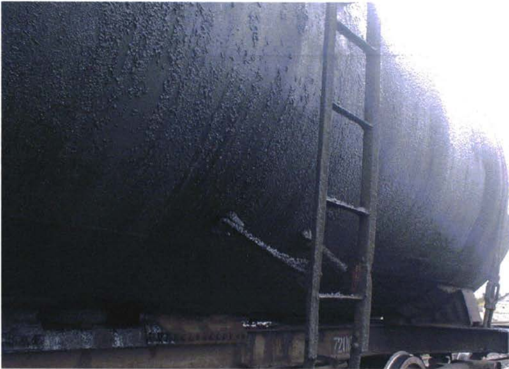
Рисунок 19: Загрязнённая цистерна в результате переполнения
