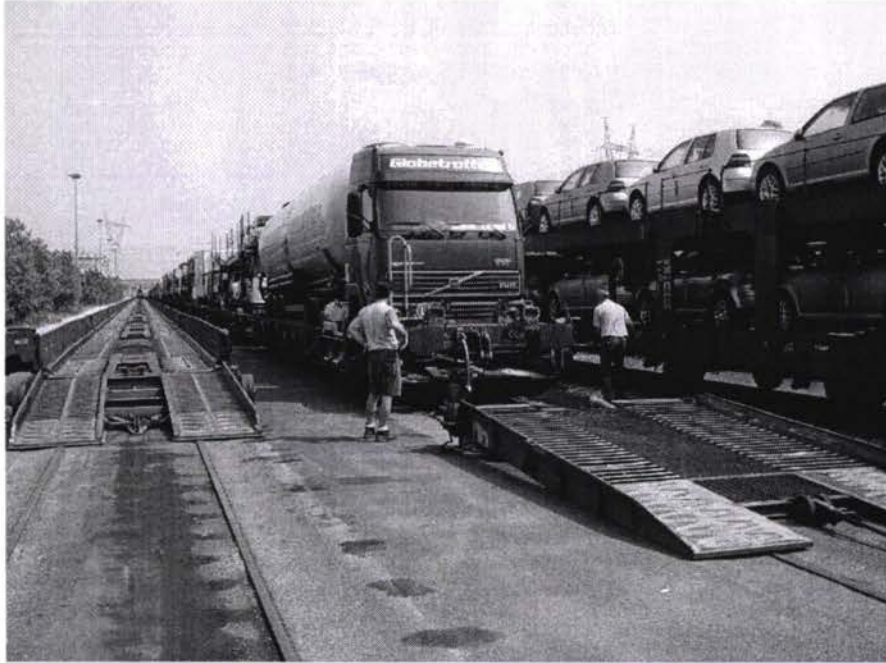
Поезд перевозящий грузовой транспорт, установка эстакады
