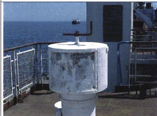
Вентиляция, ось может поворачиваться, решето частично покрашено.
