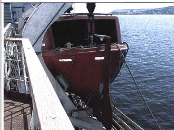
Спасательная лодка правая сторона, 52 человека, плохое состояние, но годная к использованию
