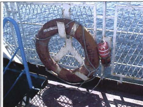
Спасательный круг правого борта, аварийная лампа без патрона и колбы, батарея не работает
