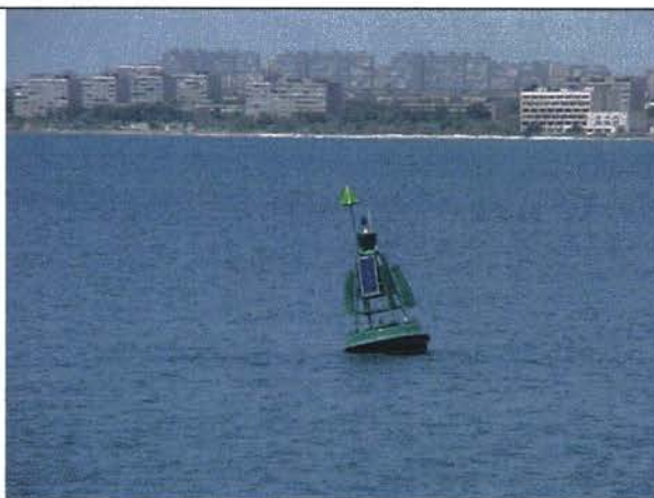
Правая сторона буя с радарным рефлектором, солнечным и световым коллектором
