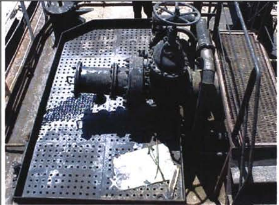
Манифольд танкера "Генерал Гейдаров", 4987 тонн, рукава рассоединены
