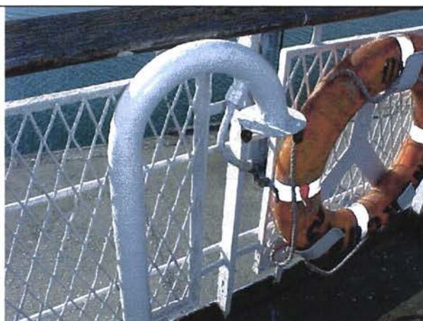
Спасательный круг и аварийная лампа без патрона и колбы
