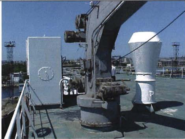
Оба крана спасательного плота без электрической поддержки, кабеля испорчены, не подлежат использованию
