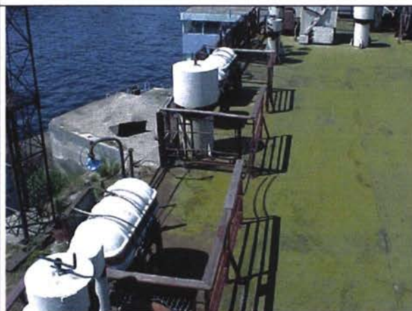
Палуба корабля, по каждой стороне 3 спасательных плота: 2 для 20 и 1 для 12 человек, изготовлено в России, нет таблицы для проверки и управления
