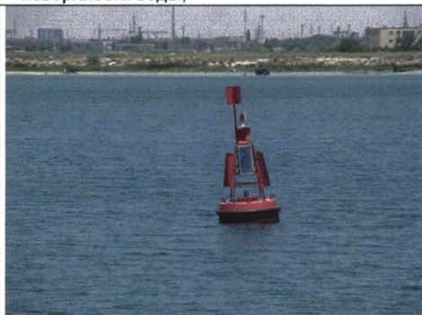
Фарвартер буя с радарным рефлектором, с солнечным и световым коллектором
