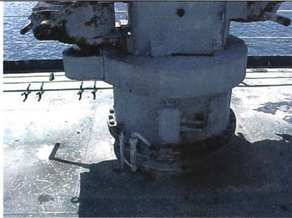
Оба крана спасательного плота без электрической поддержки, кабеля испорчены. не подлежат использованию
