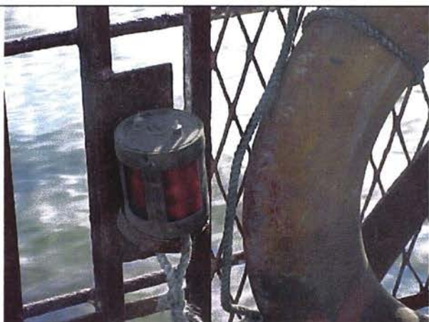
Спасательный круг, без названия, покрытие испорчено и водонепроницаемо, свет без батареи, патрона и колбы
