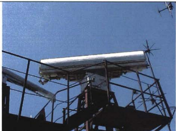
Антенна для 3 и 10 см радара с Радарного контрольного центра порта и прибрежной зоны.
