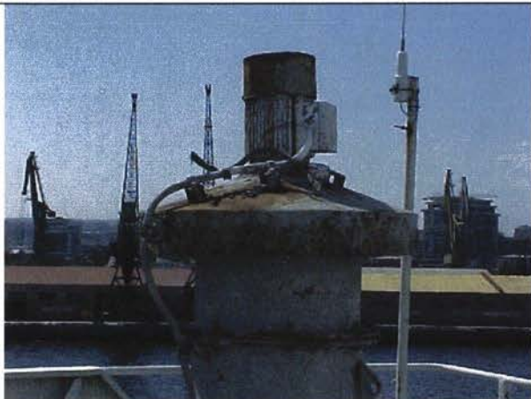
Оба крана спасательного плота без электрической поддержки, кабеля испорчены, не подлежат использованию
