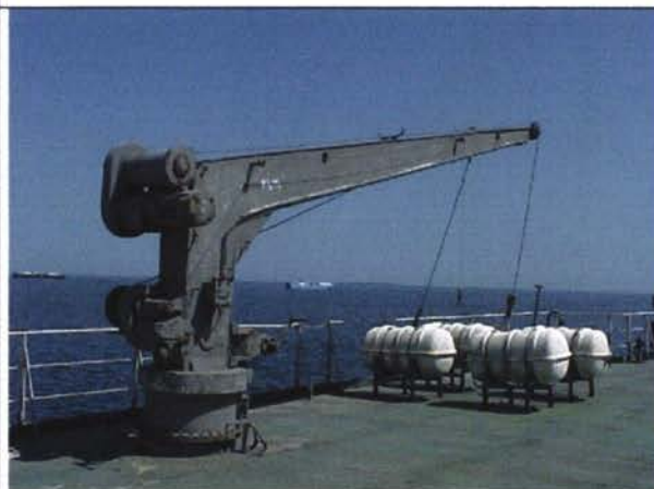
Спасательные плоты и кран, около порта, по каждую сторону 4 спасательных плота, изготовленные в ГДР, без описания, только один имеет метку: следующая проверка 6/1986
