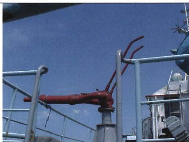
Гидромонитор для воды и пены на корабле "Радуга" используемый для сбора мусора сточных вод и нефти с поверхности воды,
