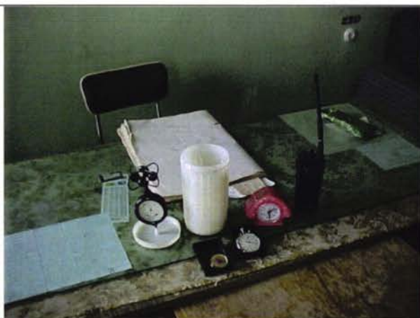
Оборудование ЦУП Дубенди, измеритель скорости ветра с емкостью, будильник, наручные часы без браслета, оперативный журнал регистрации показаний секундомера и переносное радио с частотами только VHF и служебными каналами
