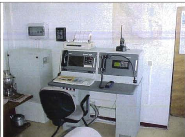
Радиостанция Рэйтон с телекомом, VHF, MW, СГОМБ и переносным радио со служебными каналами
