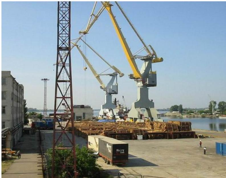
АО «Херсонский судостроительный завод» круглогодично предоставляет услуги по перевалке грузов различных типов, включая контейнеры и негабаритные грузы, поступающие по водным путям, железным и автомобильным дорогам. Причальная стенка длиной 365 м оборудована двумя порталными кранами грузоподъемностью по 100/16
